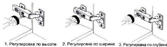
Схема регулировки петли
