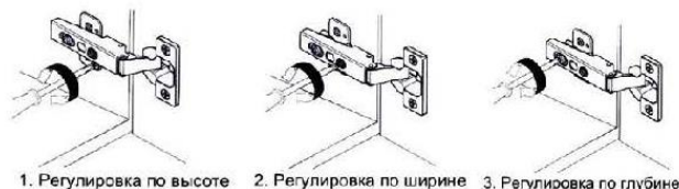
1. Регулировка по высоте 2. Регулировка по ширине 3. Регулировка по глубине
