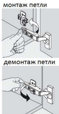
Схема монтажа петли
