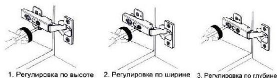
Схема регулировки петли
