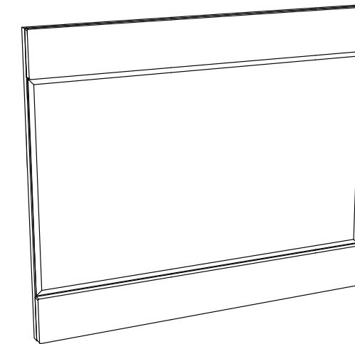
Габаритные размеры (мм): 720x32x600 мм
