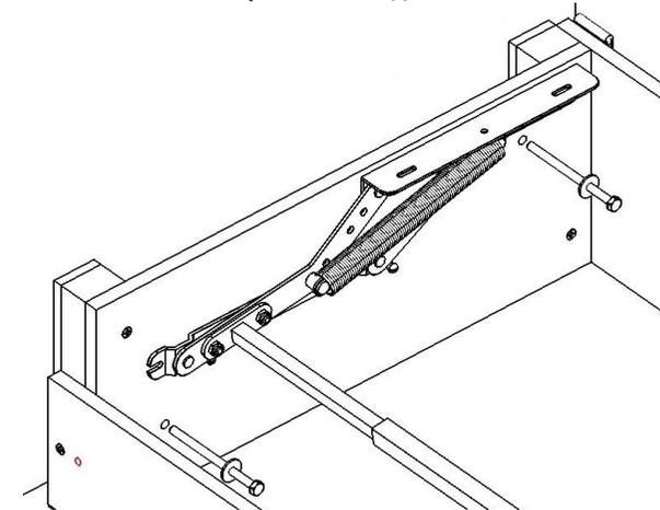
Схема соединения основания и оттоманки
